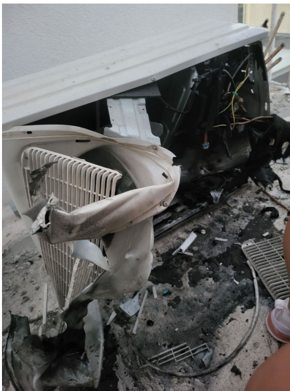
Εικόνα 1: Έκρηξη κλιματιστικού κατά τη διάρκεια προσθήκης ψυκτικού αερίου
